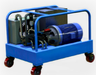
Гидравлическая насосная станция
